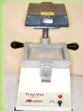
Figura 15. Máquina de vacío y calor para planchas termoplásticas.
